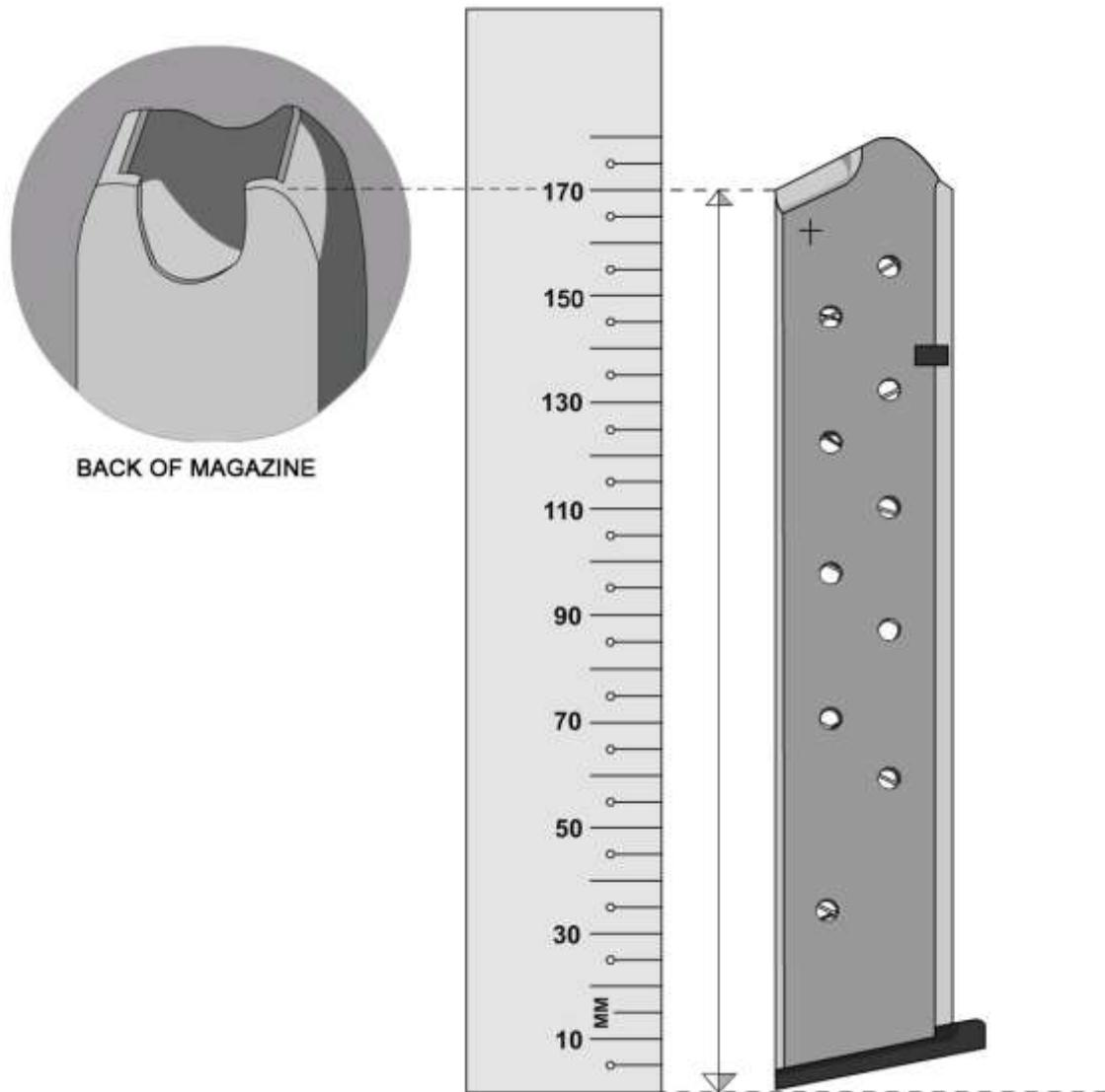
Das Magazin steht senkrecht auf einer ebenen Fläche wobei die Messung von der Fläche aufwärts zum Rücken der Zuführlippe gemacht wird, wie illustriert. Es sind nur gerade, steife Magazine zulässig (Beispiel: flexible, gebogene, „J“, „L“, „T“ oder ähnliche Magazineformen sind verboten)
